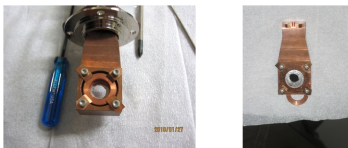
図 2: フィルター固定用ジグに収まった際の試料の様子。左から Si 基盤 (CZ)、Si 基盤 (FZ)。
