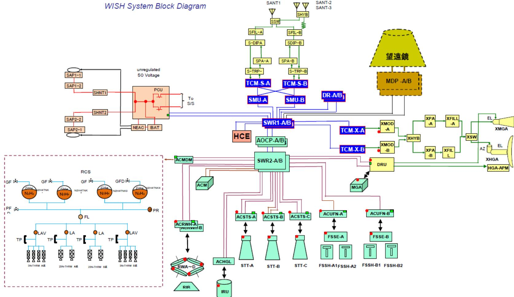
図3.2-1 WISHシステムブロック図 System Block Diagram
