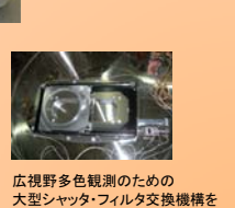
広視野多色観測のための大型シャッター・フィルタ交換機構を試作、試験中
