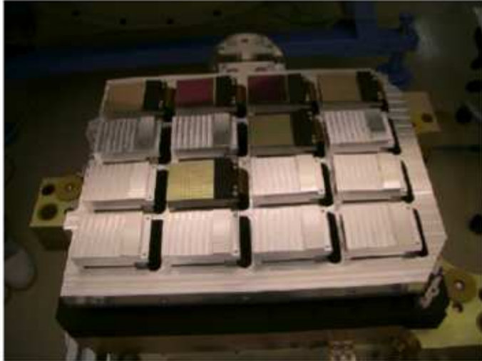
[図 3-10: VISTA 用に 16 個の VIRGO のマウントをモザイクした様子； 2 個の検出器と 4 個のマルチプレクサが実際に搭載されている。(Finger et al. 2006) ]
