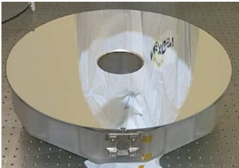
[図 3-5 : 回折限界を達成したひので衛星の 50 cm 主鏡 (14 kg)]
