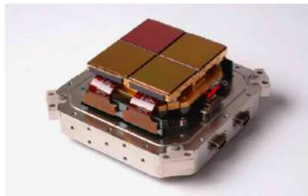
[図 3-9: 4 個の H2RG をモザイクした様子 (Finger et al. 2006) ]
